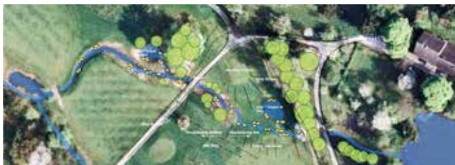
Ausgleichsmaßnahme – Offenlegung des Hasselbaches
